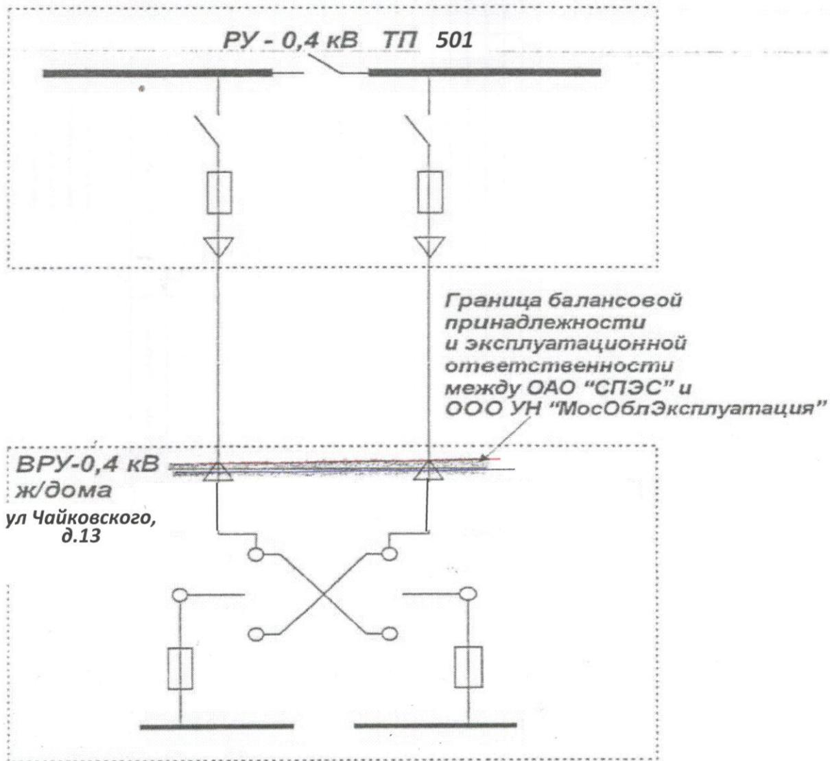
**Примечание:** в схеме указываются места установки и номера приборов учета, параметры измерительных трансформаторов тока и напряжения, границы балансовой принадлежности (красный цвет) и эксплуатационной ответственности (синий цвет), границы с субабонентами/транзитными потребителями (зеленый цвет), длина и марка питающих кабелей (проводов).
